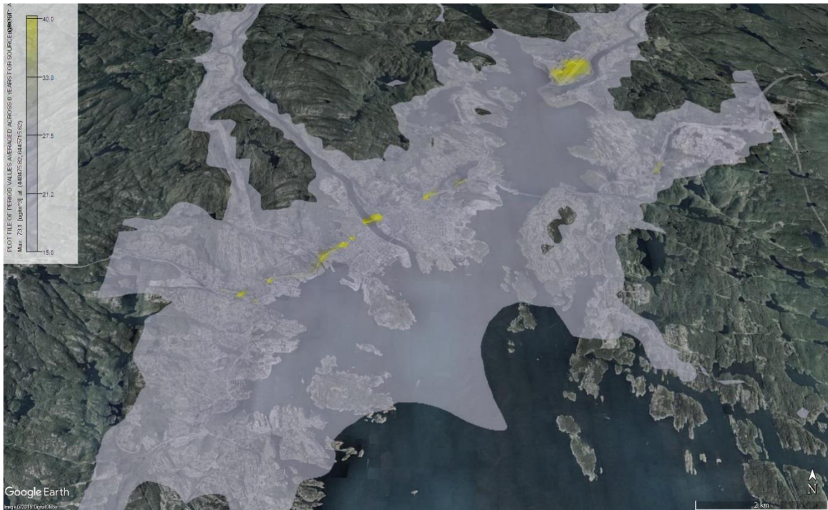
Figur 31: Vintermiddelmåling av NO 2 fra alle kilder inkludert bakgrunnskonsentrasjoner (skala strekker seg fra 15 – 40 µg/m 3 ).
