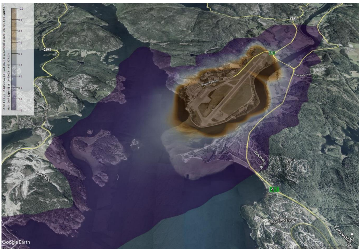
Figur 7: Kartet viser årsmiddelskonsentrasjonen av NO 2 fra flytrafikken på Kjevik (skala strekker fra 1 – 10 µg/m 3 )
